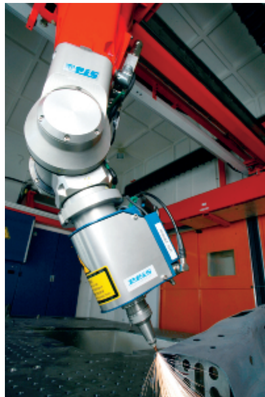
Beim Laserroboter RV16L-FT werden durch das im Unterarm integrierte Lichtleitkabel die beiden Handachsen überbrückt.
