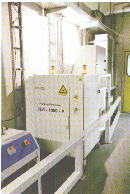
Links: Der IPG-Faserlaser leistet 2 kW, was für die zu bearbeitenden Blechdicken zwischen 1,2 mm bis 1,5 mm mehr als genug ist. Rechts: Armaturen für die Robotersteuerung und Medienversorgung.
